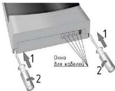
Рисунок 2 – Снятие крышки клеммного отсека
